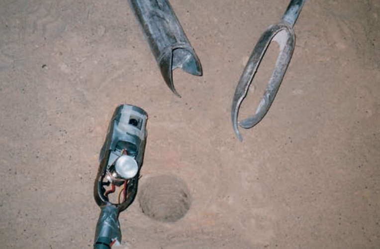
44 ▲ AFBEELDING 28: De kop van een handboor met flexibele spot en mini-camera.
